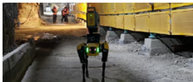
**Inspección y medición automatizada de proyectos**
